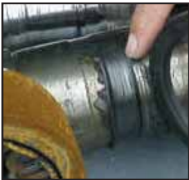
Wellenschaden durch Radialwellendichtring
