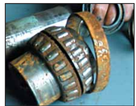
Durch Feuchtigkeit kontaminierte Lager.
