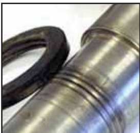
Wellenschaden durch Labyrinthdichtung
