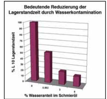
Das Ergebnis einer Untersuchung eines größeren Schmieröherstellers ergab, dass ein Wasseranteil von nur 0,002% die Lagerstandzeit um bis zu 48% reduzieren kann.
