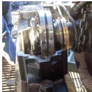
Papier & Zellstoffindustrie, 70mm LabTecta-PB™ installiert in ein SKF® SNL 516-613 Stehlager (Anwendungsbeispiel Ref: 3217)
