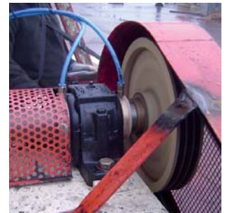
70mm LabTecta-PB™ mit Luftsperrschloss an einem Lüfterstehlagerblock SKF® SNL 516-613 (Anwendungsbeispiel Ref: 3218)
