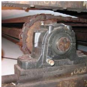
Papier & Zellstoffindustrie, LabTecta-PB™ installiert an einer Trocknerrolle (Anwendungsbeispiel Ref: 3369)
