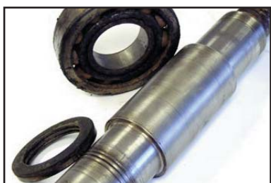
Wellenschaden durch Labyrinthdichtung.
