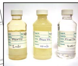
RWD Test: Lagerölproben zur Laboranalyse.
