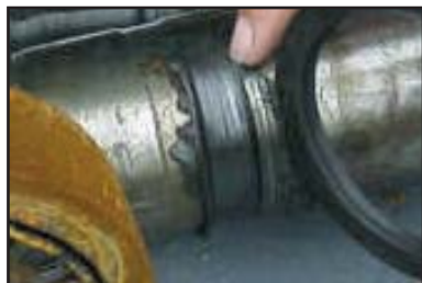
Wellenschaden durch Radialwellendichtring.
