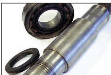
Wellenschaden durch Labyrinthdichtung.
